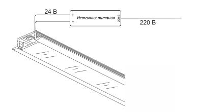
Источник питания устанавливается за пределами корпуса профиля в электромонтажном шкафу, или за потолочным пространством
