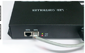
Рис. 2. Подключение контроллера HX-801RC к мастер-контроллеру или компьютеру.
