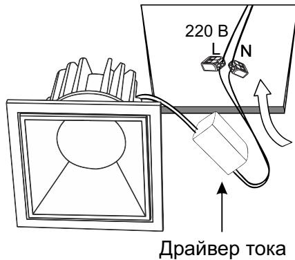
**3** Поднимите клипсы и установите светильник в отверстие.
