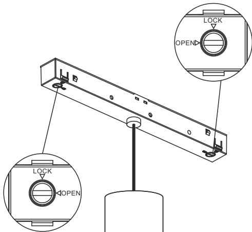
**2** Установите адаптер светильника в шинопровод до щелчка
