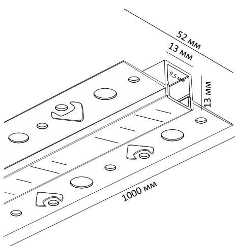
Комплект алюминиевого профиля LINEAR 1313 F предназначен для освещения при помощи интеграции в него светодиодной ленты.
