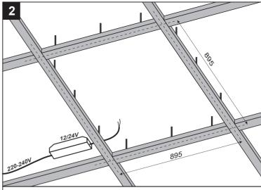
В запланированном месте размещения светильника соберите, заранее, на потолке по указанным на схеме размерам каркас для установки светильника. Подведите электрический кабель и подключите к нему источник питания.
