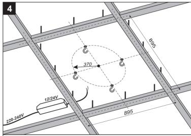
Установите анкерный болт с крюком (входит в комплект светильника) в черновой потолок с учетом радиуса их установки от центра светильника 370 мм, мест размещения страховочных петель на куполе и места подключения (боковое отверстие в куполе) источника питания к светодиодной ленте.
