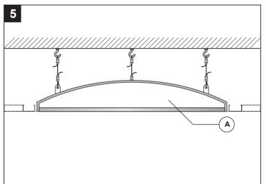
Закрепите страховочные тросы (входят в комплект светильника) в страховочных петлях на куполе. С помощью страховочных тросов подвесьте купол (A), как указано на схеме, за анкерный болт с крюком в один уровень с каркасом для установки светильника.
