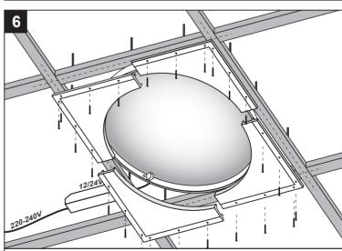
Закрепите основание светильника к каркасу потолка саморезами (входят в комплект светильника)
