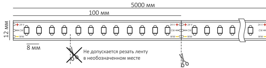
Ленту можно резать строго в указанных местах, между контактными площадками для пайки.
