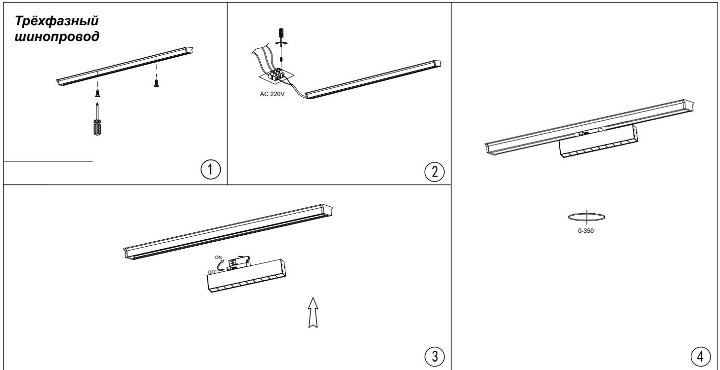
**ВНИМАНИЕ.** Все работы по монтажу шинопровода и установке светильников, замене ламп и техническому обслуживанию следует проводить при отключенном напряжении питания шинопровода. Категорически запрещается производить перемещение светильников вдоль шинопровода во включенном состоянии.
