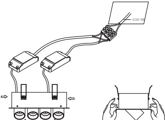
Закрепите светильник в подготовленном отверстии.
